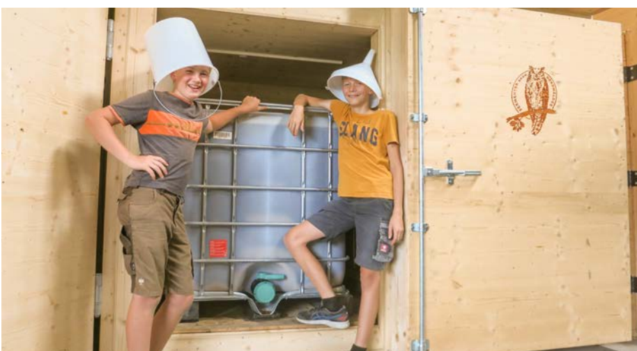
Im Nordwälder Fermenter können 2.000 Liter RM fermentiert werden
